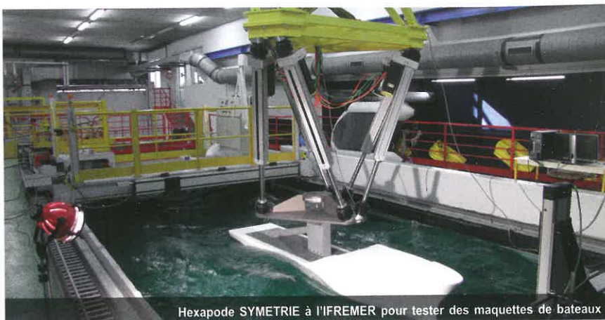
Hexapode SYMETRIE à l'IFREMER pour tester des maquettes de bateaux
