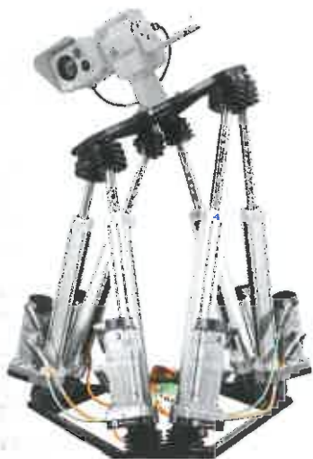
Hexapode NOTUS utilisé par Exavision pour tester le système de stabilisation de ses caméras
