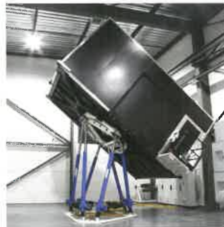
Hexapode SIROCCO utilisé par la DCNS pour entraîner des équipages de sous-marins
