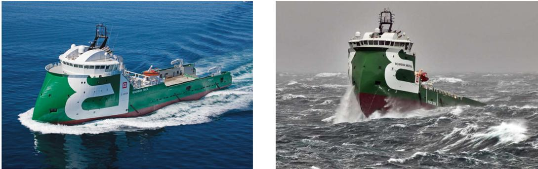
FIGURE 6.1 – Vue de navires Bourbon de type Étrave inversée par mer calme et forte
