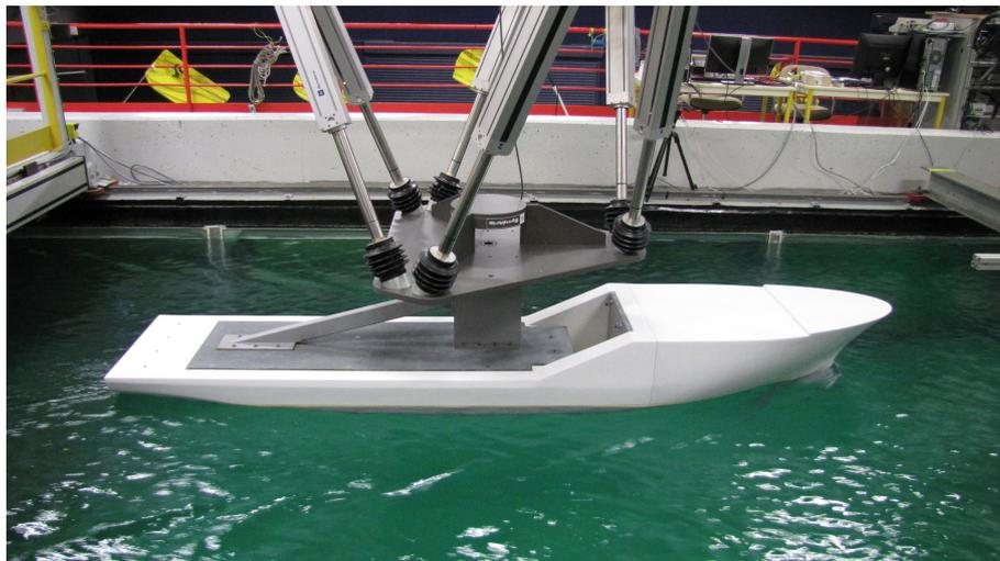
FIGURE A.2 – Illustration du montage réalisé avec la maquette du *Pourquoi pas ?* à l'échelle 1/30 fixée sous l'hexapode
