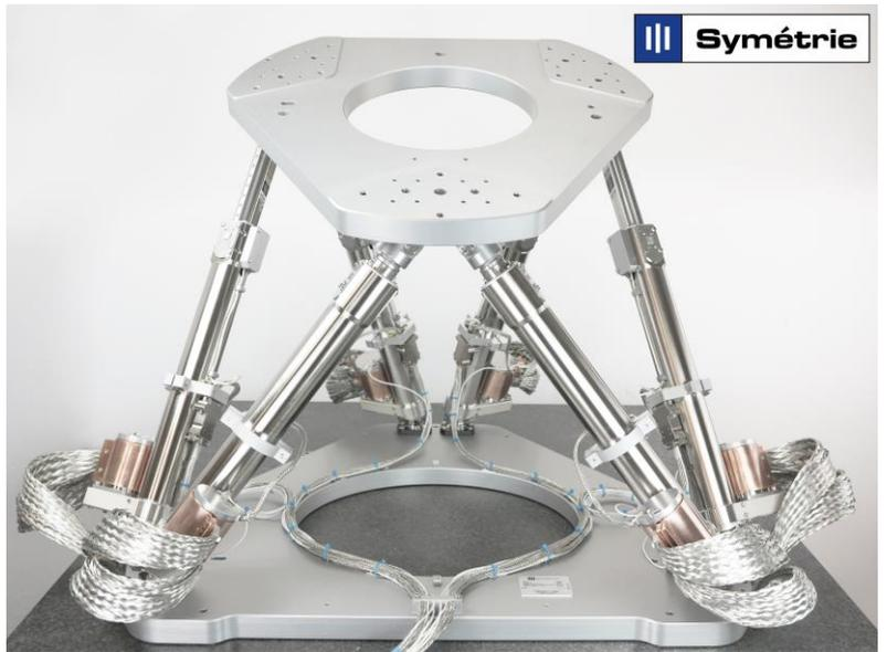
**Symétrie a livré un hexapode ZONDA à l'IAS à Orsay pour les tests en vide thermique et l'étalonnage de 13 caméras de la mission PLATO (PLANetary Transits and Oscillations of stars), dont le lancement est prévu en 2026.**
