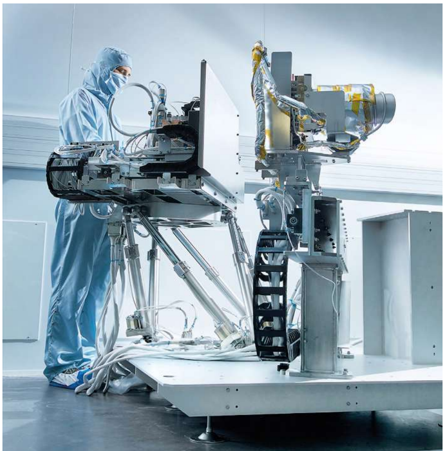
Figure 5. Hexapode en salle blanche ISO5 intégré dans un banc de test optique - Crédits : Bertin Technologies
