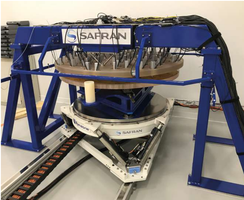
Figure 6. Hexapode intégrant une rotation additionnelle servant à vérifier la qualité des segments du miroir primaire M1 de l'ELT de l'ESO - Crédits : SAFRAN REOSC
