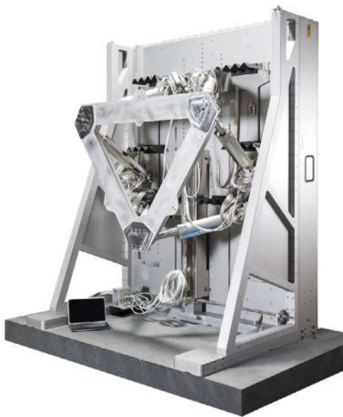
Figure 4. Hexapode compatible vide installé à l'horizontale sur une translation additionnelle - Crédits : Symétrie
